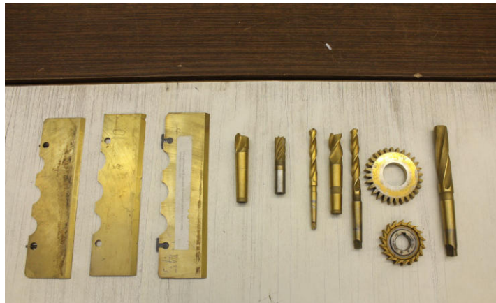
Обрабатывающие инструменты, прошедшие процедуру ионно-плазменного напыления с нанесением покрытия TiN
