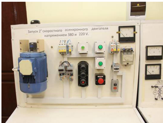
Запуск 2-х скоростного 3-х фазного асинхронного двигателя
