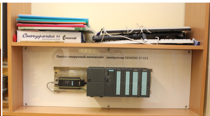
Стенд для изучения работы программируемого логического контроллера
