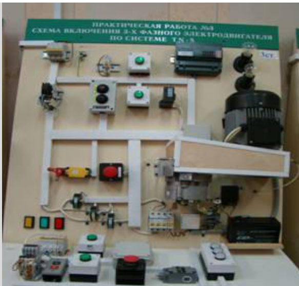
Схема включения 3-фазного электродвигателя по системе TN-S
