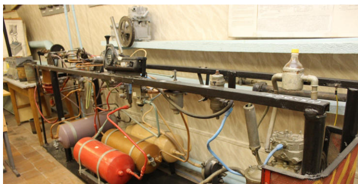
Схема пневматического привода тормозных механизмов автомобиля КАМАЗ
